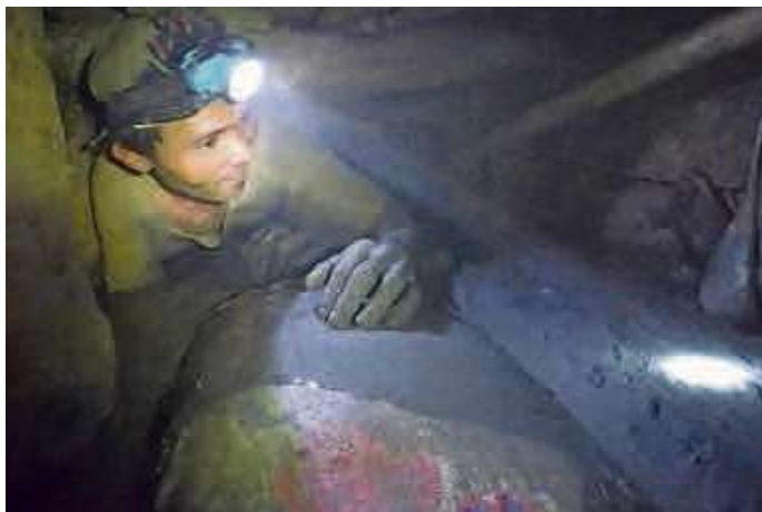
Der Goldgräberschacht ist oft nur einen halben Meter hoch.
